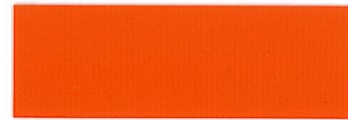
1123F キャロットオレンジ 透光率 4.0% 紫外線遮蔽率 100.0% マンセル値 色相 (H)8.70R 明度 (V)5.75 彩度 (C)13.46
