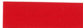
1122F ハイレッド 透光率 4.08% 紫外線遮蔽率 100.0% マンセル値 色相 (H)6.29R 明度 (V)4.63 彩度 (C)14.41
