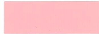
1127F ローズピンク 透光率 3.1% 紫外線遮蔽率 100.0% マンセル値 色相 (H)9.76RP 明度 (V)7.63 彩度 (C)6.59
